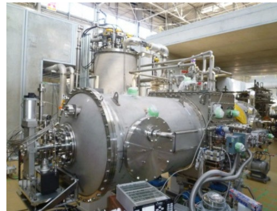
cERL 1.3 GHz ML Cryomodule
